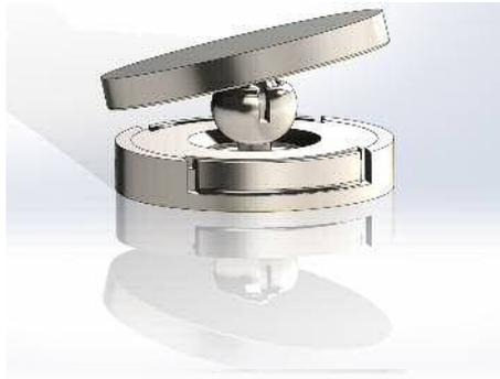
Ein stufen- und richtungsloser Toleranzausgleich (patent-pending) ist in einem Radius von  $\pm 3\text{mm}$  in der „Standard Version“ bzw.  $\pm 6\text{mm}$  in der „erweiterten Version“, bei einer geringen Aufbauhöhe, möglich.
